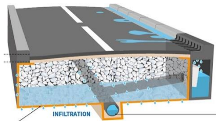
Figure 2 : Principe chaussée réservoir
